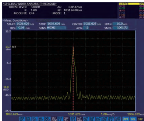
분해능 설정: 0.05nm, Span : 10nm, 측정 감도: HIGH1
